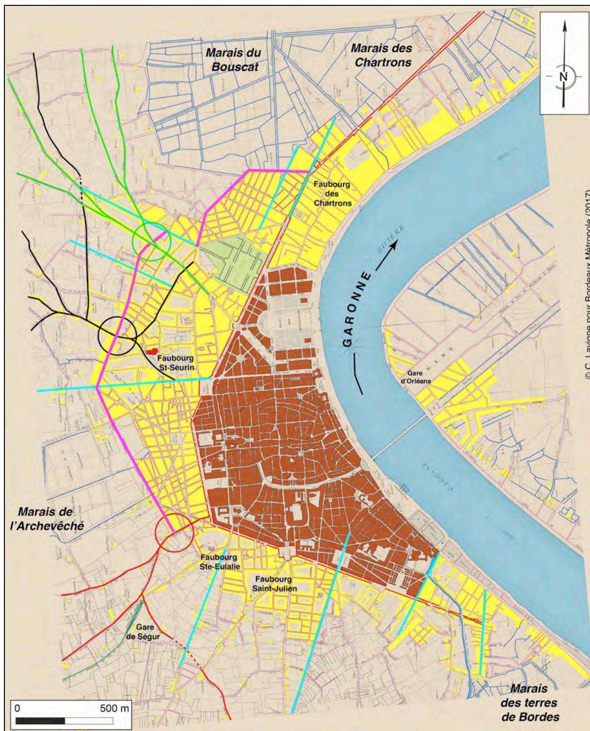
Fig. 11 : L'analyse du réseau des voies montre une dynamique contradictoire de la fabrique de l'espace urbain orientée à la fois vers la maîtrise de l'extension de la ville (alignement remarquable de rues formant limite à l'urbanisation, en rose) et vers l'organisation de son développement futur (percées, en bleu turquoise), d'après le Plan de la ville de Bordeaux réduit sur le grand plan levé par P. E. Pierrugues et D. Béro, 1835 .
