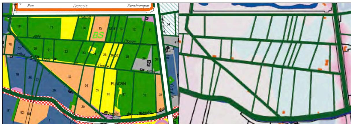
Fig. 114 : Le classement des sols du quartier de Plassan dans les catégories T3 et T4 (à gauche, en vert et jaune) s'explique par l'excès d'humidité provoqué par le talus de la route de Pauillac qui bloque la circulation de l'eau vers la Garonne, formant une cuvette (à droite).
