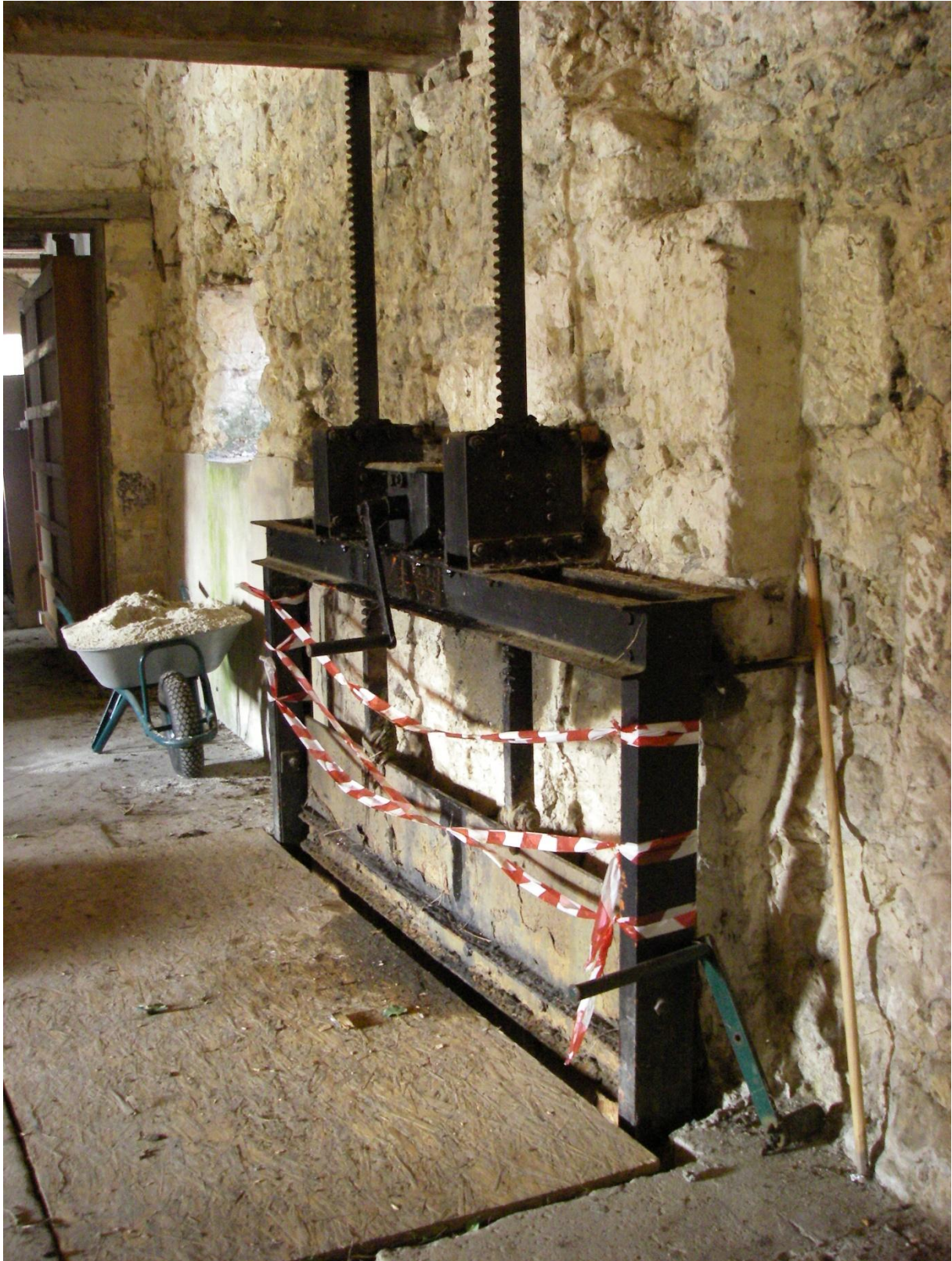
Vanne motrice de la roue horizontale du moulin, 2013 (cl. Fabrice Demarty, Bordeaux Métropole)
